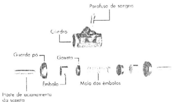
fig. 12 — cilindro de roda-típico
