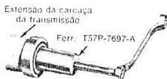
fig. 31 — remoção da bucha da extensão da carcaça da transmissão
